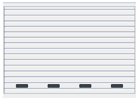
Motif 480, panneau à sections avec grilles d'aération Section d'aération : 40 cm 2 / grille
