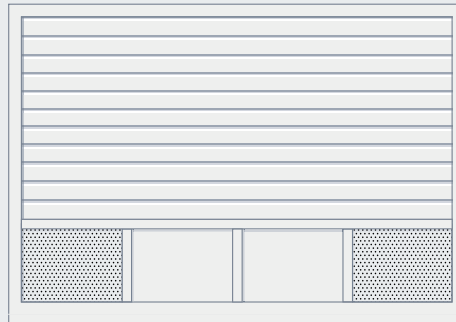
Motif 499 , exemple avec panneaux à sections, à tôle perforée et en tôle d'aluminium
